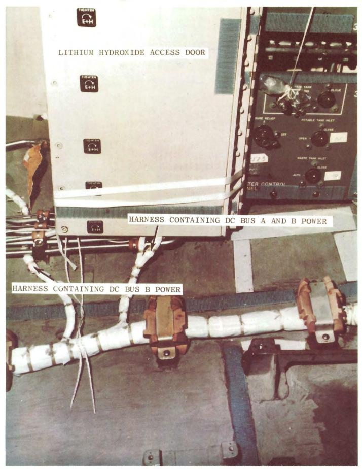
SPACECRAFT 014 ENVIRONMENTAL CONTROL SYSTEM INSTRUMENTATION HARNESS
